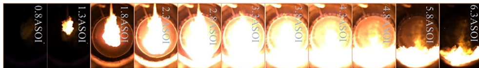
(d) Methanol auto ignition before diesel combustion.
