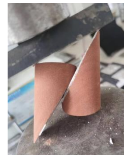
(d) Specimen with 60° Dip Angle
